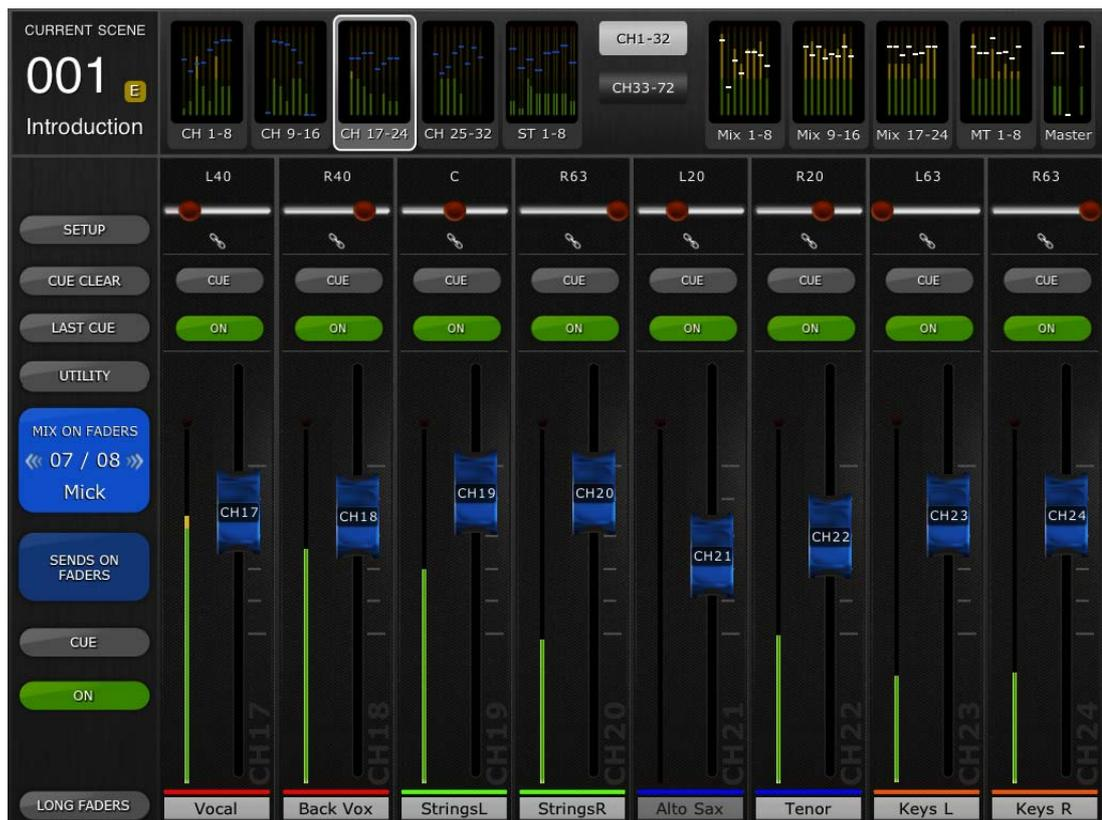
Une large touche [MIX ON FADERS] (Mixage de faders activé) affiche le numéro et le nom du bus Mix actuellement sélectionné. La couleur de cette touche correspond à celle des touches utilisées sur la console de série CL.
