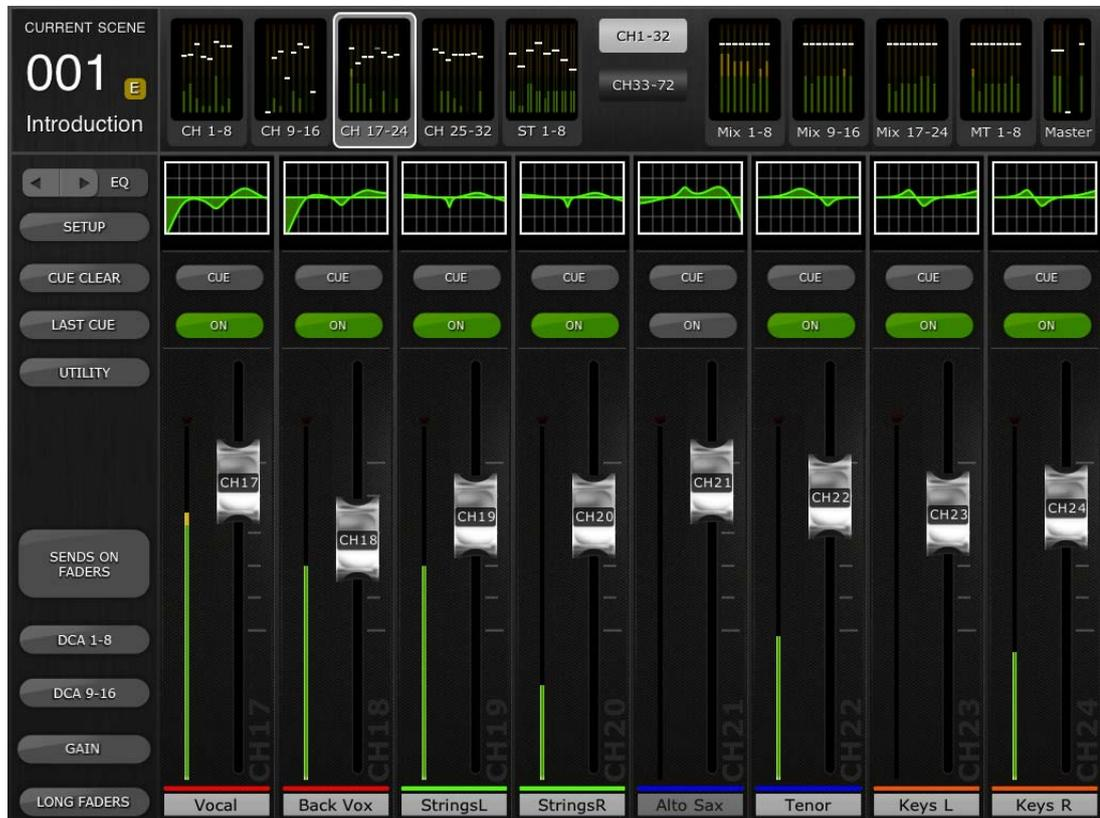
Dans la partie supérieure de l'écran, les indicateurs de niveau et les faders s'affichent par blocs de canaux correspondant respectivement aux canaux d'entrée mono 1-32, aux canaux d'entrée stéréo 1-8, aux bus Mix et Matrix ainsi qu'aux bus master stéréo et mono. Il s'agit de ce qu'il est convenu d'appeler « Navigation/Meter Bridge » (Navigation/Bandeau de bargraphes).
