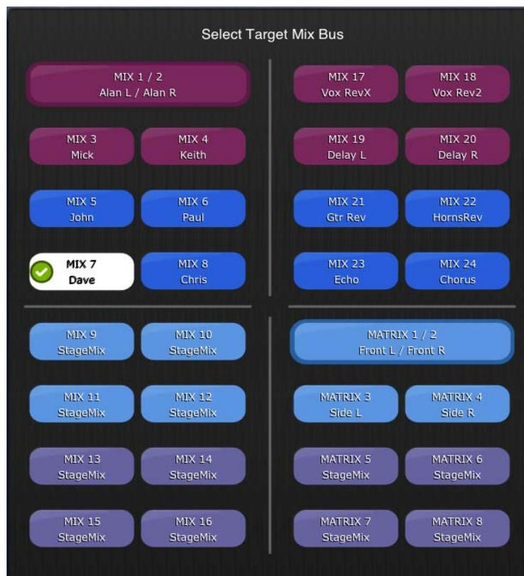
Choisissez le « bus Mix de destination » parmi les bus Mix 1-24 et les bus Matrix 1-8. Le bus Mix actuellement sélectionné s'affiche sous forme d'une touche blanche contenant une coche. Les paires stéréo apparaissent sous forme de grandes touches simples (sans coche).
