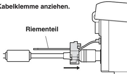
Den Riementeil fassen, die Kabelklemme bis zum Anschlag verschieben, und dann fest anziehen.
