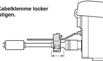
Die Kabelklemme im oben gezeigten Bereich locker befestigen.
