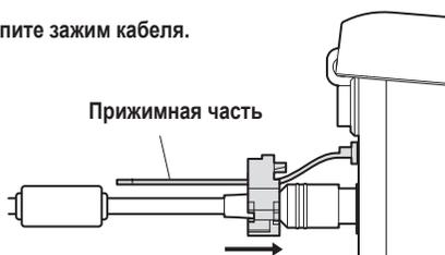
Возьмитесь за прижимную часть, передвиньте зажим кабеля до упора, а затем плотно затяните его.
