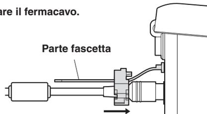
Afferrare la parte della fascetta, spingere il fermacavo finché smette di muoversi e fissarlo poi saldamente.
