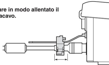
Fissare in modo allentato il fermacavo nell'area mostrata sopra.
